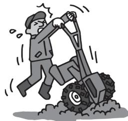
下敷きになることがあります。そのときにロータリーが回転していると転んだ上に機械が進んできて、足や腹部をロータリーに巻き込まれることがあります。そのような事故を防ぐために、「バック耕耘けん制装置」が備えられています。バックしようとするときに、ロータリーのクラッチが入っていると変速ギアがバックに入らないようになっています。ロータリーを停止位置にすればバックに入ってから後退発進が可能になり、発進時に転んでしまい巻き込まれても作業機によるダメージは小さくできます。
