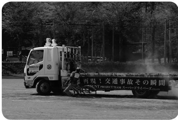
内輪差による巻き込み事故の再現
