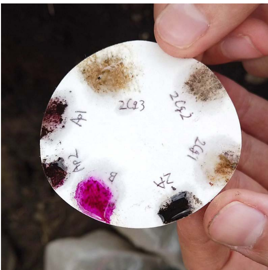
▷活性アルミニウム試験 火山灰の影響を受けていると赤く変色する
